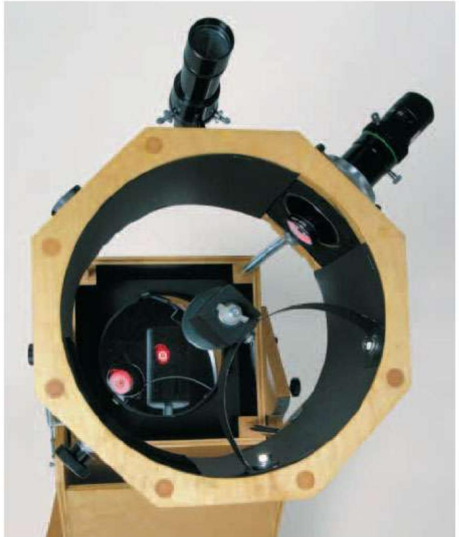
Un collimatore laser standard può fornire un allineamento ottico insoddisfacente. Tuttavia, usando questo strumento con una normale lente di Barlow consente di raggiungere una collimazione pari a alla precisione ottenuta con un buon oculare *Cheshire*. Tutte le fotografie sono di Craig Michael Utter, Sky & Telescope.
