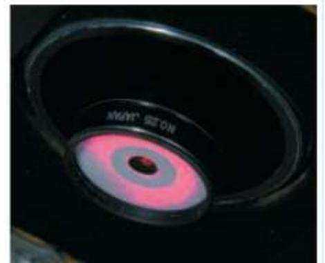
**Questa sequenza di fotografie mostra che con la combinazione del laser barlowato la collimazione è così semplice come regolare l'inclinazione dello specchio primario finché il contorno dell'ombra del centro del primario (un anello di rinforzo per fogli forati, in questo caso) è centrato nel foro d'uscita dello schermo della Barlow.**
