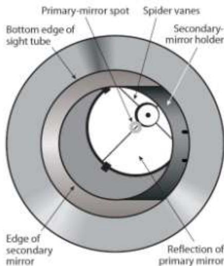
**Il primo passo della collimazione è stato eseguito – lo specchio secondario è meccanicamente centrato rispetto al tubo del foceggiatore. Quando eseguite questo passo ignorate tutti i riflessi**
