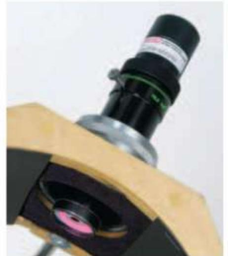
**Sopra a destra:** Inserendo il collimatore laser nella lente di Barlow equipaggiata col suo schermo forato, vi trovate per le mani uno strumento capace di fornire una collimazione tanto accurata quanto quella fornita da un oculare *Cheshire*, ma con la convenienza di un laser.
