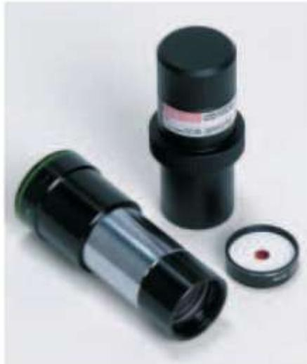
**Sopra a sinistra:** Il Laser barlowato consiste in tre pezzi principali: un normale collimatore laser, una lente di Barlow e uno schermo che consiste in un disco di cartoncino montato sul telaio di un filtro colorato (rosso in questo caso).
