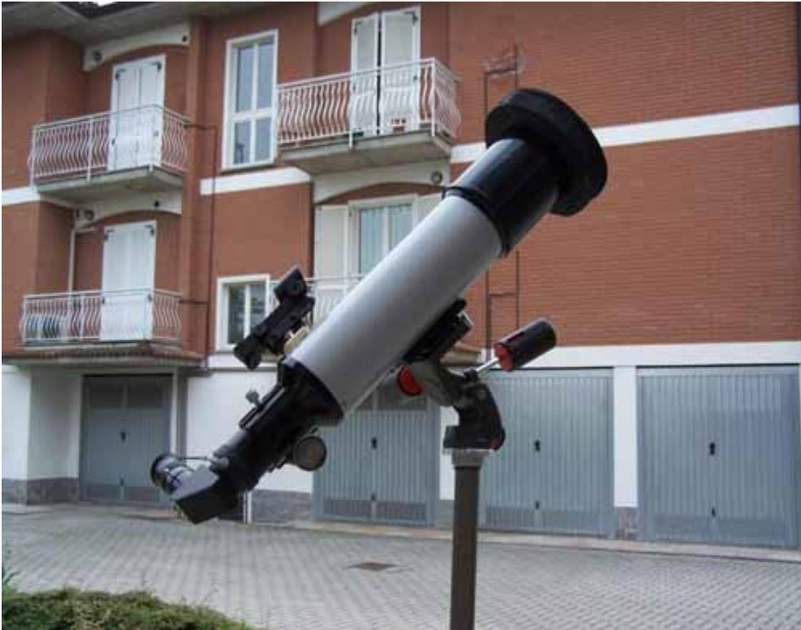
Quando dovrò sostituire la pellicola, sarà sufficiente svitare tre viti, attaccare con del nastro adesivo il nuovo filtro di astrosolar e riavvitare, 5 min al massimo
